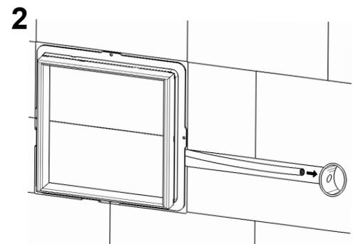
Verbindung zur Verteilerdose herstellen: Kabelkanal schlitzen bzw. Netzkabel durch Wandbohrung führen, Netzkabel in entsprechende Verteilerdose einführen.
