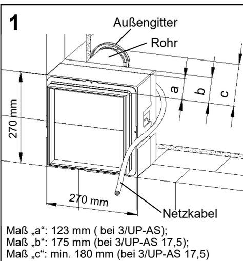
Rohr auf Ausblasstutzen aufsetzen und Verbindung mit Kleband abdichten, ggf. Rohr am Styroporgehäuse ankleben. Achtung: Bei der Wahl der Rohrlänge auch Dicke der Dämmung und Außenfassade berücksichtigen! Unterputzgehäuse zusammen mit dem aufgehenden Mauerwerk einsetzen! Netzkabel nach vorn herausstehen lassen!
