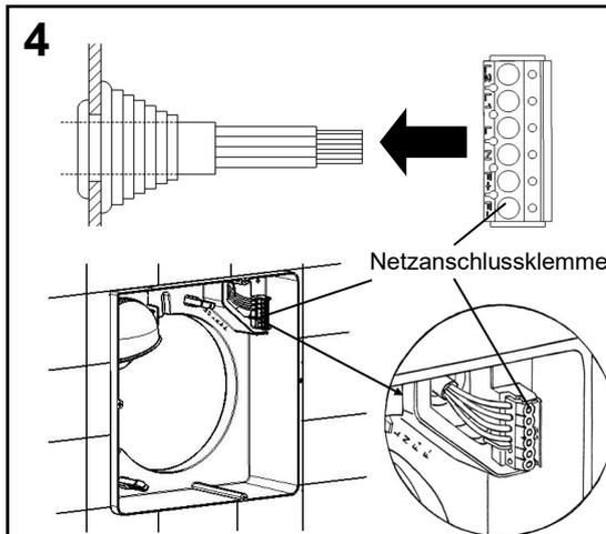
Netzanschluss: Putzschutzdeckel abnehmen! Netzanschlussklemme entsprechend des gewählten Anschlussbildes montieren (siehe E96). Putzschutzdeckel wieder aufsetzen! Fertigmontage entsprechend Einbauanleitung E 96 „Silvento Unterputz-Gehäuse 1 und 2-Raum“ bzw. den Einbauanleitungen für die Ventilatoreinsätze!
