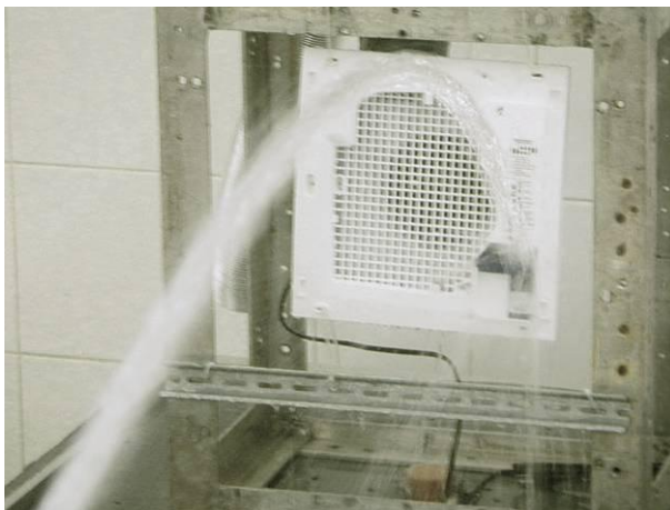
Bild 3 Prüfling Nr.1 im Prüfgestell positioniert mit genormtem Strahlwasser an der Funktionsplatte nach der Strahlwasserschutzprüfung IPX5
