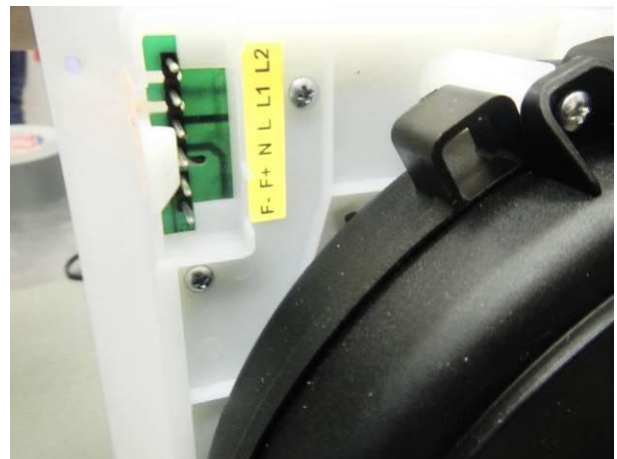
Bild 4 Prüfling Nr.1 (geöffnet) keine erkennbaren Wasserspuren am Leitungsanschluss nach der Strahlwasserschutzprüfung IPX5
