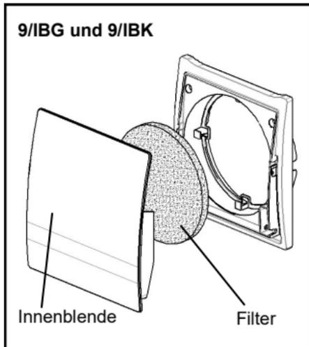
Rasten Sie nach dem Einlegen des Filters die Innenblende in Offenstellung ein.
